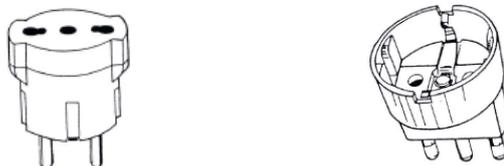
Spine di tipo tedesco (Schuko) possono essere inserite in prese di tipo italiano solo tramite un adattatore che trasferisce il collegamento di terra effettuato mediante le lamine laterali ad uno spinotto centrale. E' assolutamente vietato l'inserimento a forza delle spine Schuko nelle prese di tipo italiano. Infatti, in tale caso dal collegamento verrebbe esclusa la messa a terra.
