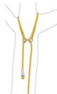
Fig. 8 - Ancoraggio passante per corda raddoppiata
