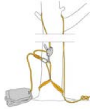
Fig. 7 - Ancoraggio svincolabile della fune alla base dell'albero
